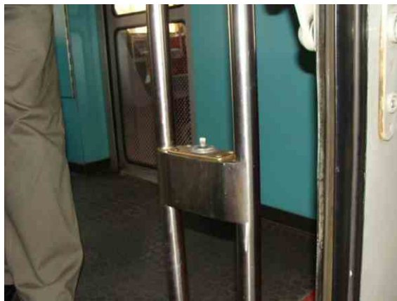
4. ábra A távzáró kapcsoló elhelyezése
