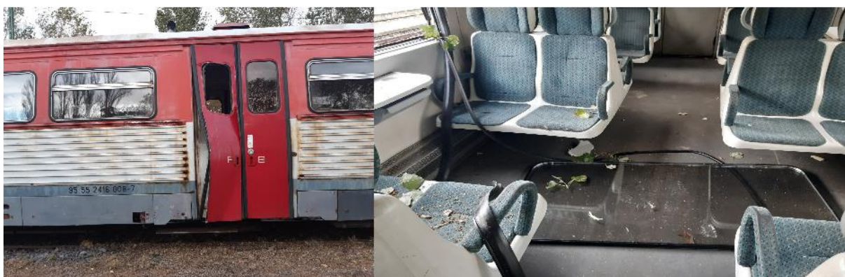
2. kép: Vonat ütközése úrszelvényben lévő akadállyal (faág) Mátéházapuszta és Baja állomások között, 2023.10.27.
